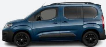
他車のドアなどが接触した際にボディを守るための大きなサイドプロテクター（衝撃吸収パネル）が
