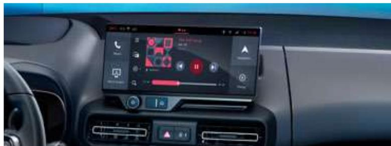
タッチスクリーンは8インチから10インチへサイズアップ。高精細で美しい画面はスマートフォン同様にスワイプ操作可能。また通信モジュール(4G)も搭載されOTA(Over The Air)によるシステムソフトウェア更新も可能です。
